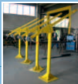
Strutture di sollevamento per miscelatori in costruzione. Mixer's lifting systems under construction.
